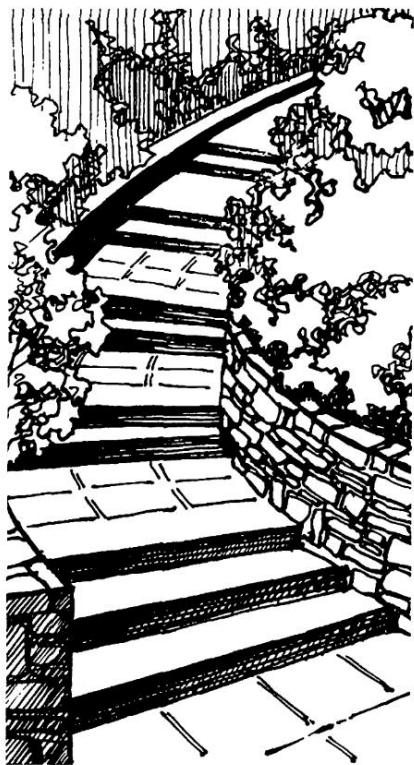
Рис. 2.37. Лестница и подпорная стенка на крутом склоне
