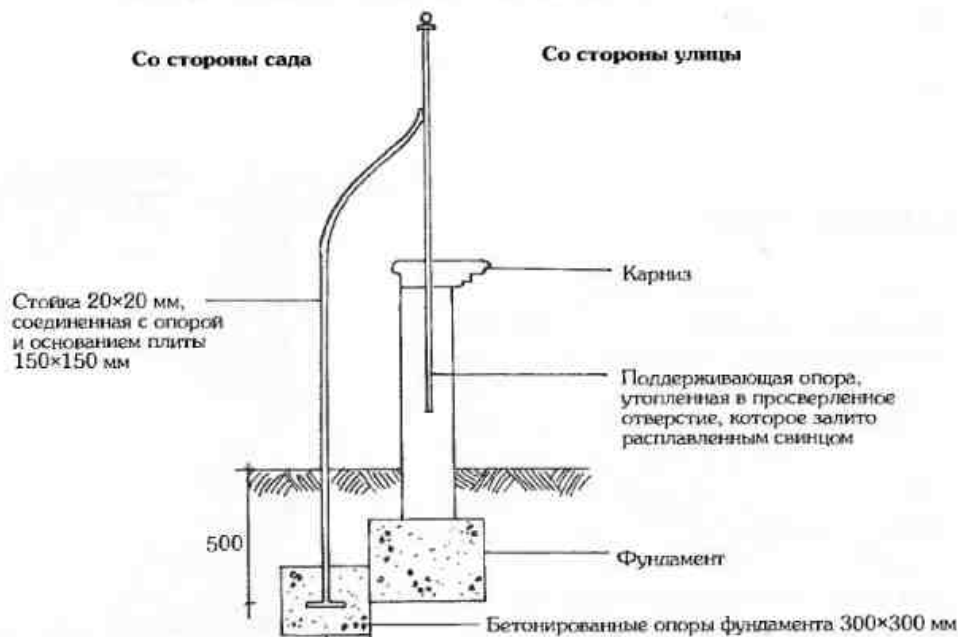
СЕКЦИЯ ПЕРЕДНЕЙ СТЕНЫ НА ОПОРАХ (ВИД СБОКУ)
