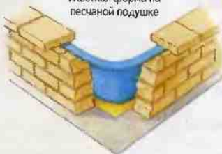
Водонепроницаемая пленка из полистирола завернута на углах
