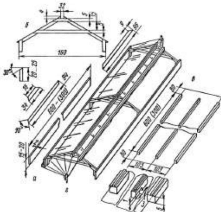
Рис. 28. Разборно-переставной пленочный парник с солнечным обогревом:
