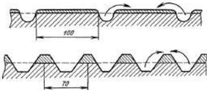
Рис. 1. Поделка гряд и гребней (пунктиром показан уровень почвы до поделки гряд и гребней; размеры даны в см)
