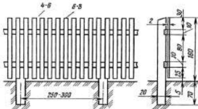
Рис. 8. Устройство деревянного забора (размеры даны в см)
