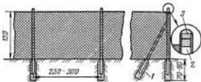
Рис. 9. Устройство сетчатого забора на трубчатых столбах:
