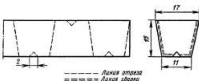
Рис. 30. Схема нарезки горшочков из полистиреновой пленки (пунктиром показана линия отреза, двойным пунктиром — линия сварки)
