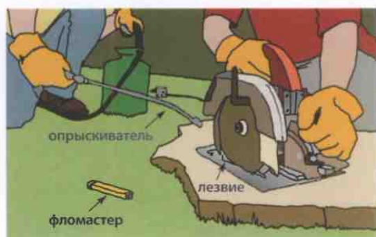
Рис. В. При резке и распилке камней не забывайте смачивать лезвие водой. Для этого можно использовать приспособления для опрыскивания растений.
