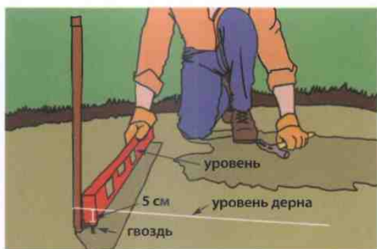
4. Для выравнивания площадки воспользуйтесь длинными гвоздями или колышками. Вбейте один в центре, чтобы он был ниже уровня дерна на 5 см. Двигаясь к краю, вбейте еще 5-6 гвоздей. Выровняйте их с помощью уровня. Наметьте еще несколько радиусов. Засыпьте площадку песком. Утрамбованный песок должен скрыть шляпки гвоздей.
