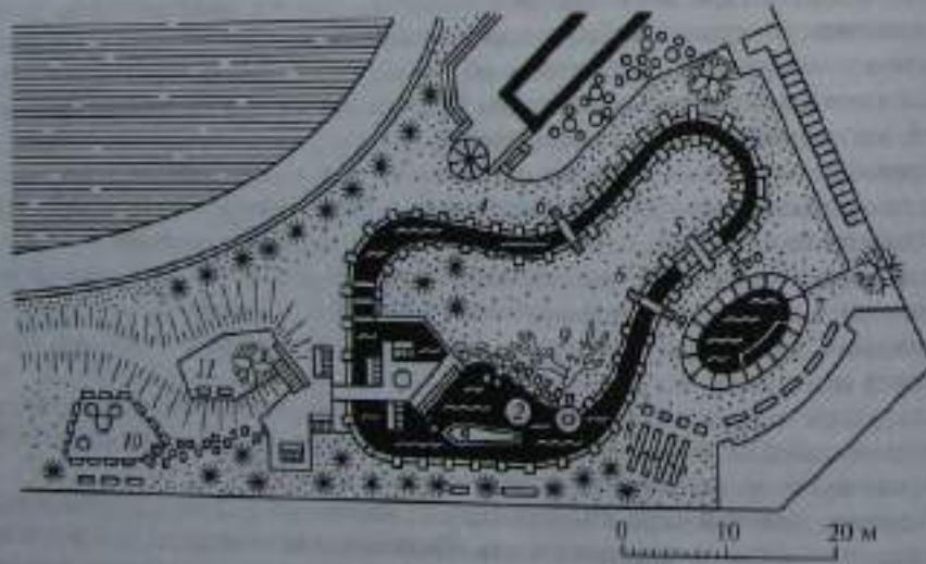
Рис. 3.26. План детского игрового комплекса в парке Гренхен в Цюрихе (Швейцария): 1 — «Маяк»; 2 — «Корабль»; 3 — «Деревня на сваях»; 4 — ручей-канал; 5 — туннель из бетонных элементов; 6 — арка для лазанья; 7 — плескательный бассейн; 8 — качалка; 9 — дерево для лазанья; 10 — песчаная площадка; 11 — видовой терраса на холме
