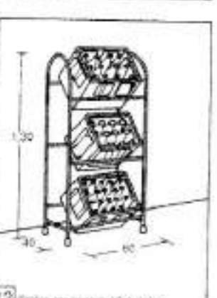
12 Стойка для хранения с бутылками
